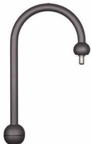
Kleine Glocke, Mastbogen, Mastbogen, fluchtend, aus Stahl, verzinkt, lackiert, Siteco® eisenglimmer (DB 702S), 1armig, Durchmesser: 60mm, Höhe: 829mm, Zopfmaß: 60mm (Aufsatz), Verpackungseinheit: 1 Stück
