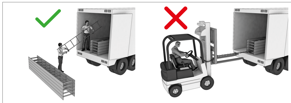
Abb. 1: Entladen der Kabeltrassen
