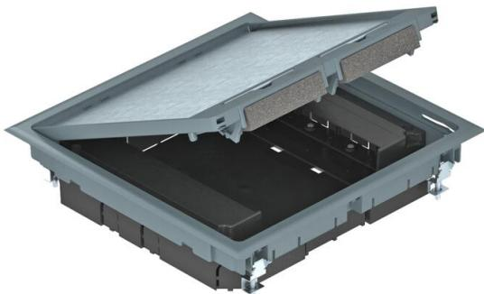
Geräteeinsatz GES9 mit einer festen Bauhöhe von 55 mm für den Einsatz in Installationskanal-Systemen in trockenen Räumen mit trocken gepflegten Fußböden im Innenbereich. Mit zwei Einbaugehäusen zur vertikalen Montage von Modul 45-Geräten und vier Zugentlastungen. Zur Montage der Modul 45-Geräte werden zwei Einbaurahmen benötigt.
