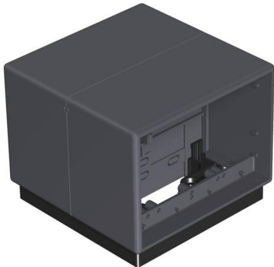
Zum kombinierten Einbau von 4 einzelnen Installationsgeräten mit Tragebügel (4 Installationsgeräte einer Stromart oder jeweils 2 Installationsgeräte zweier Stromarten). Die verschiedenen Stromarten werden durch eine Trennwand gegeneinander isoliert. Schraubbefestigungsspur für Installationsgeräte: 60 mm senkrecht.
