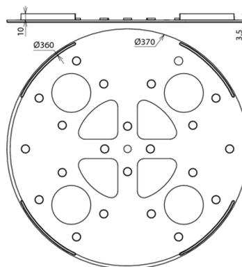
Unterlegplatte zum Schutz der Dachbahnen unter dem Betonsockel, Ausführung groß für das Gewicht 17 kg.
