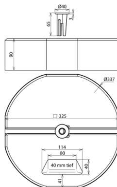
Betonsockel mit Gewineadapter für Fangstangen Ø16 mm mit Gewinde M16, zum Schutz von kleineren Dachaufbauten auf Flachdächern.
