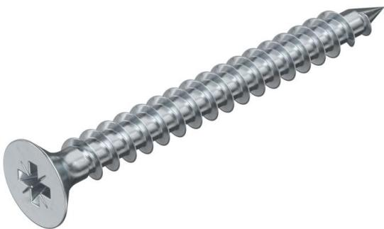
Stahl gehärtet, galvanisch verzinkt und hostaflonbeschichtet. Senkkopf mit T-Bit (Innensechsrund), die Gr. Ø 3 mm T10, Ø 3,5 mm T15, Ø 4 und 4,5 mm T20, Ø 5 mm T25.
