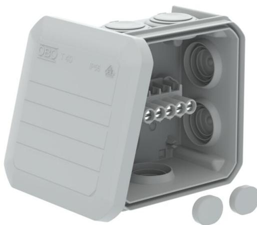
Kabelabzweigkasten mit Klemmleiste zum Verbinden von Kabeln und Leitungen im Innenbereich und geschützten Außenbereichen. Quadratische Form mit Einstektdichtungen an den Seiten und Ausschlageöffnungen im Boden. Geeignet für die Wand-/ Deckenmontage und die Montage auf Montageblechen. Mit der Möglichkeit zur Innenbefestigung. Mit festsitzendem Klemmdeckel. Hergestellt aus halogenfreien und UV-resistenten Materialien.
