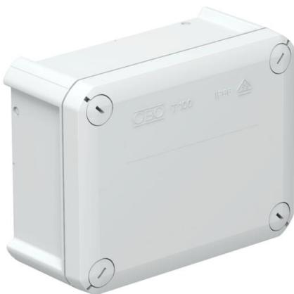
Kabelabzweigkasten zum Verbinden von Kabeln und Leitungen im Innenbereich und geschützten Außenbereichen. Rechteckige Form ohne Einführungen. Geeignet für die Wand-/ Deckenmontage und die Montage auf Montageblechen. Mit der Möglichkeit zur Innenbefestigung und Montage über die Eckdome. Deckel mit Schnellverschluss, plombierbar. Hergestellt aus halogenfreien und UV-resistenten Materialien.
