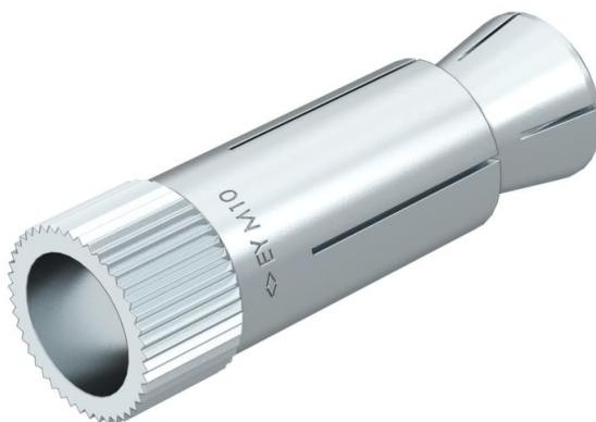
Hohldeckenanker Easy für die Montage in Spannbeton-Hohldeckenplatten. Beim Anziehen der Schraube oder der Mutter wird der Konus von der Ankerhülse gelöst und in diese hineingezogen. Dadurch spreizt der Dübel im Hohlräum auf und erzeugt einen Formschluss. Der Hohldeckenanker kann auch eingesetzt werden, wenn der Spreizbereich nicht in einer Hohlkammer liegt.
