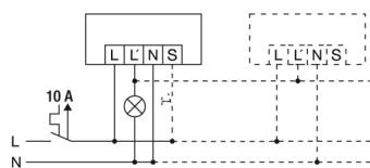
Standardbetrieb mit der zusätzlichen Ansteuerung durch Schließstaster.
