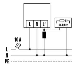
Bei Schaltung von Induktivitäten (z. B. Relais, Schütze, Vorschaltgeräte) kann der Einsatz eines RC-Filters (A) erforderlich sein.
