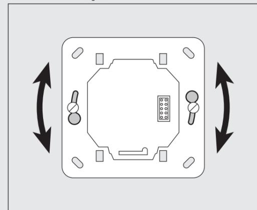
5. Alle Federn des Bediengerätoberteils exakt in die Öffnungen des Unterteils einschieben.
