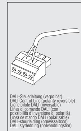
3. Anschluss-Stecker anstecken; Bediengerätunterteil einbauen
