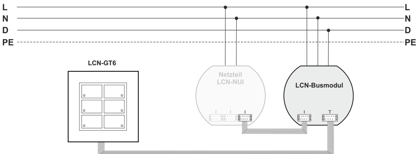
Netzteile LCN-NUI (optional) für Tasten-Hinterleuchtung und Corona®-Lichtkranz
