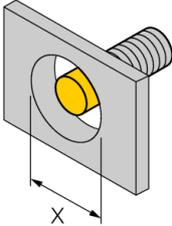
Bei allen nichtbündigen *uprox*®+ Gewinderohrschaltern ist ein Einbau bis zur Rohrkante erlaubt. Ein sicherer Betrieb ist hierbei mit einer maximalen Reduzierung des Schaltabstandes von 20% gewährleistet.
