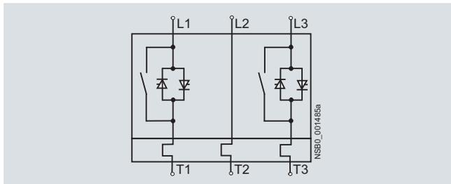
Überbrückungskontaktsystem (Bypass) und elektronisches Überlastrelais sind bereits im Sanftstarter 3RW40 integriert und müssen daher nicht separat bestellt werden.
