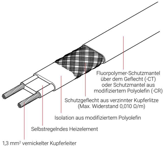
Elektrische Beheizung zum Frostschutz ohne Dampfspülung.
