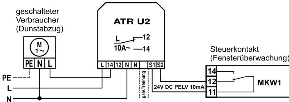
Für die Steuerung einer Dunstabzugshaube wird am Magnetkontakt MKW 1 der Öffner beschaltet.
