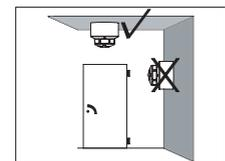
Der Thermodifferenzialschalter TDS 247 darf gemäß folgender Abbildung nur auf eine waagerechte Fläche montiert werden. Des Weiteren muss ein Abstand von 0,5 m zu jeglichen Installationen eingehalten werden.
